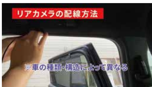
③センターピラーに配線
