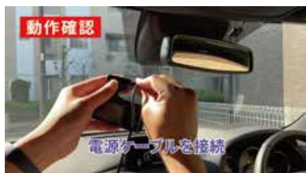
電源ケーブルを接続
