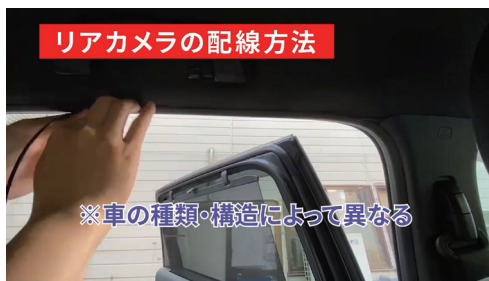
③センターピラーに配線
