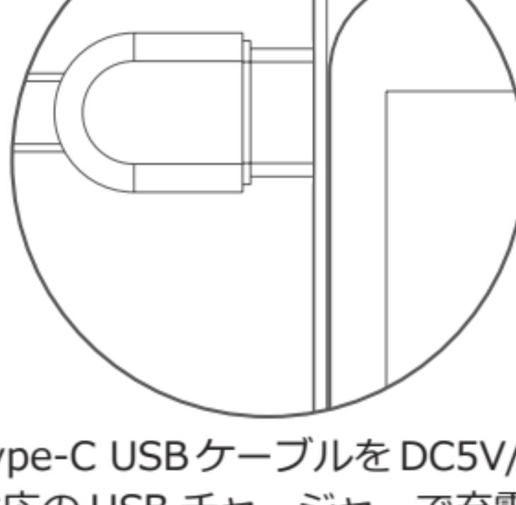
Type-C USBケーブルをDC5V/1A対応のUSBチャージャーで充電を行ってください。
