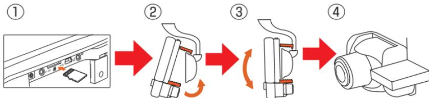
※本製品はSDカードよりコンパクトなmicroSDカード規格のメモリーカードを使用するため人や取り付ける環境によってメモリーカードの挿入や取りはずし際に注意事項がございます。挿入：指先やツメなどで奥まで押し込み「カチ」とするまで押しください。取りはずし：指先かツメなどで奥まで押し込み「カチ」とすれば、カードが出てきます。指やツメでメモリーカードを押し込みづらい場合は、先の細い棒状のものを使うと作業がしやすいです。
