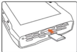
メモリーカードの金属面を下にし、カードスロットに挿入
