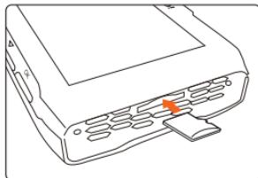
メモリーカードの金属面を下にし、カードスロットに挿入
