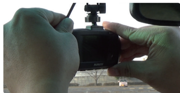
⑪ 電源ケーブルを本体へ接続
