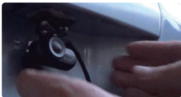
④ 位置を決めたらリアカメラを取り付け
