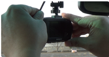
⑮ 電源ケーブルを本体へ接続
