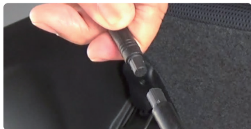
④ 位置を決めたらリアカメラを取り付け ⑤ リアカメラとケーブルを接続
