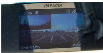
② 2つのカメラ映像の表示と記録を確認 ③ 取付位置をクリーニング
