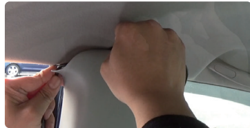
⑪ センターピラーに配線
