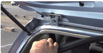
⑥ リアハッチへケーブルを配線 ⑦ 隙間に配線
