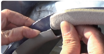
⑥ リアハッチへケーブルを配線 ⑦ 隙間に配線
