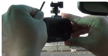
⑪ 電源ケーブルを本体へ接続
