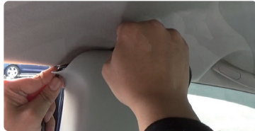
⑪ センターピラーに配線
