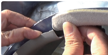
⑦ 隙間に配線
