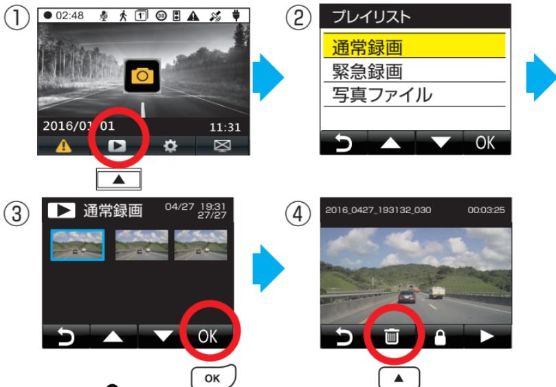
! “アイコン” は録画ファイル/写真をすでにロックし保護されていることを表します。すでにロックし保護されている録画ファイル/写真は削除できません。ロックを解除し再度操作してください。
